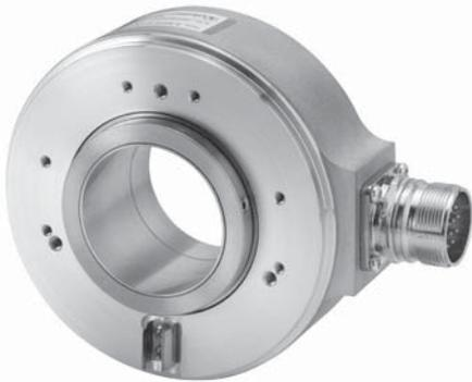
Der inkrementale Drehgeber Typ A020 mit optischer Sensorik ist mit durchgehender Hohlwelle bis maximal 42 mm Durchmesser verfügbar.
