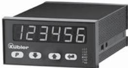
Zählerreihe für anspruchsvolle Aufgaben mit zwei individuell skalierbaren Drehgebereingängen. HTL und TTL, jeweils A, A, B, B, für Zählfrequenzen bis 1 MHz pro Kanal. Einstellbare Betriebsarten als Positions- oder Ereigniszähler, Summenzähler, Differenzzähler, Schnittlängen-Anzeige, Durchmesser-Rechner, Batch-Zähler und mehr.
