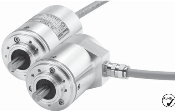
Ex-Schutz im kompakten 70 Millimeter Gehäuse aus seewasserfestem Aluminium bieten die absoluten Singleturn Drehgeber Sendix 7058 mit CANopen-Schnittstelle und optischer Sensorik.
