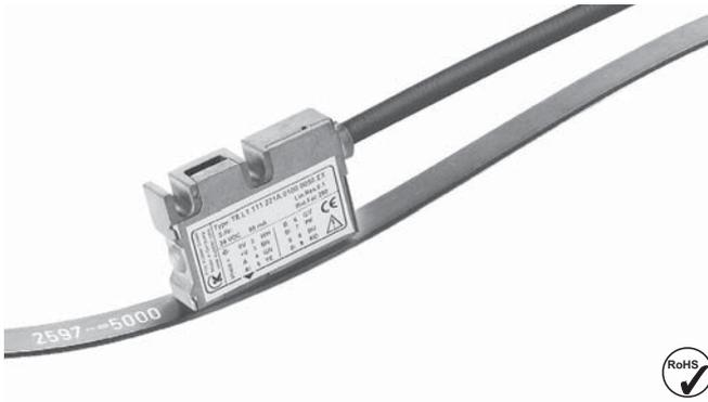
Das inkrementale magnetische Längenmesssystem LI50 / B2 – bestehend aus dem Sensorkopf LI50 und dem Magnetband B2 – ermöglicht eine Auflösung bis zu 5 µm bei einem maximalen Abstand von 2 mm zwischen Sensor und Band.
