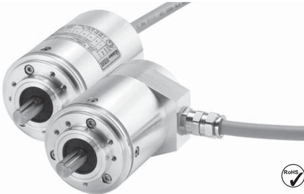
Ex-Schutz im kompakten 70 Millimeter Gehäuse aus seewasserfestem Aluminium bieten die absoluten Singleturn Drehgeber Sendix 7053 mit SSI-Schnittstelle und optischer Sensorik.
