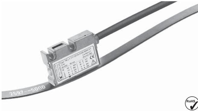
Das inkrementale magnetische Längenmesssystem LI20 / B1 – bestehend aus dem Sensorkopf LI20 und dem Magnetband B1 – ermöglicht eine Auflösung bis zu 10 µm bei einem maximalen Abstand von 1 mm zwischen Sensor und Band.
