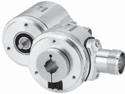
Die Singleturn Drehgeber 5852 und 5872 mit paralleler Schnittstelle und optischer Sensorik erzielen eine sehr hohe Wortwechselrate von 40 kHz bei einer Auflösung von max. 14 bit.
