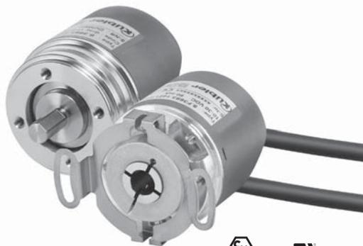
Der Sendix F36 Multiturn ist ein optischer Multiturn-Drehgeber ohne Getriebe und mit 100 prozentiger Magnet-Unempfindlichkeit - im Miniaturformat. Bei einer Baugröße von nur 36 x 42 mm misst seine Welle oder seine Sackloch-Hohlwelle bis zu 10 mm.
