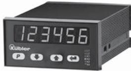
Zählerserie für anspruchsvolle Aufgaben mit zwei individuell skalierbaren Drehgebereingängen. HTL und TTL, jeweils A, A, B, B, für Zählfrequenzen bis 1 MHz pro Kanal. Einstellbare Betriebsarten als Positions- oder Ereigniszähler, Summenzähler, Differenzzähler, Schnittlängenanzeige, Durchmesser-Rechner, Batch-Zähler und mehr.
