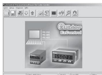
Für die Zähler mit serieller Schnittstelle ist optional eine Steuersoftware lieferbar. Damit können die Zähler einfach über einen PC programmiert werden. Im Monitorprogramm werden die Messwerte online angezeigt. Weiter Informationen über die Software EzControl erhalten Sie im Kapitel Zubehör.
